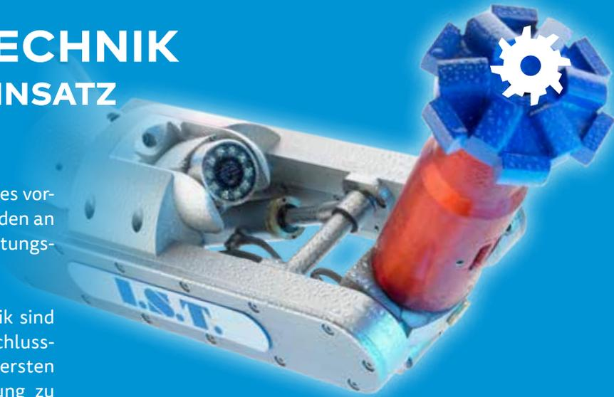
In der Folge von Kurz- und Inlinersanierungen werden mithilfe des Fräsroboters ebenfalls Einläufe wieder geöffnet, die durch die Sanierungsmaßnahmen verschlossen wurden.
